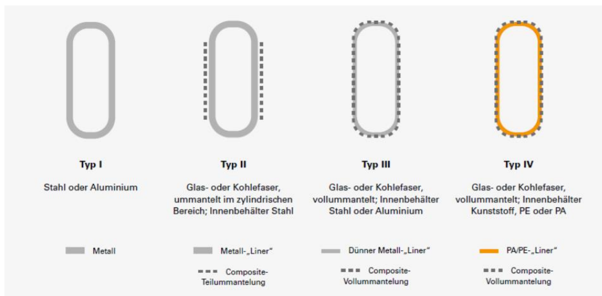
Abb. 78: Etablierte Druckbehältertypen für die gasförmige Speicherung von Wasserstoff [42]
