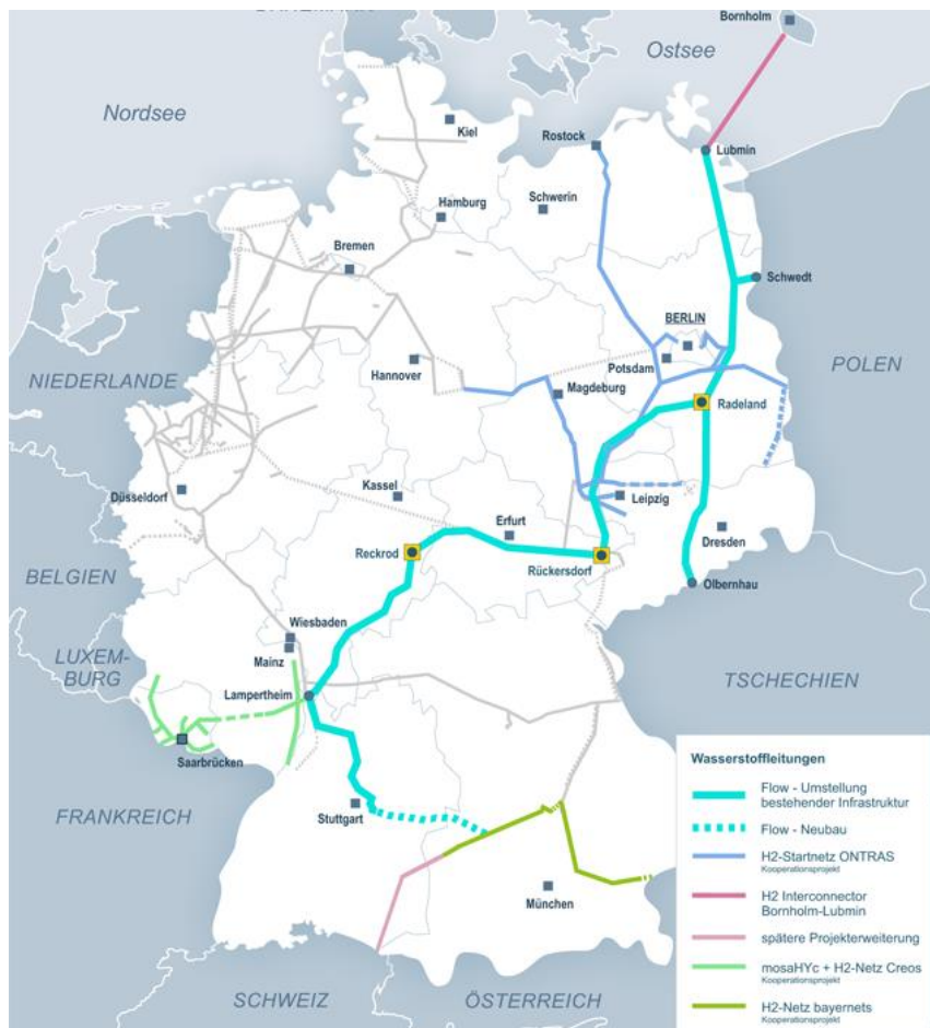
Abb. 57: Pipelineverlauf Flow Projekt, (Quelle https://www.flow-hydrogen.com/ )
