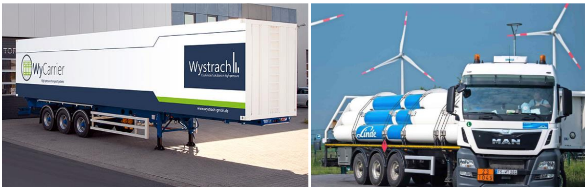
Abb. 90: Links 45 Fuß-Auflieger bis 500 bar und 1270 kg H 2 (Wystrach), links klassischer Tube-Trailer bis 200 bar (Linde)
