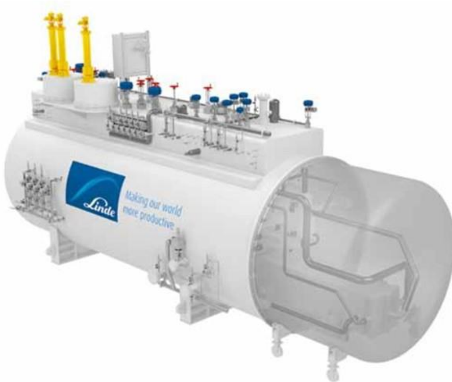
Abb. 83: LH 2 -Speicher bei -253 °C, ~4 bar, ca. 4 t Kapazität (Linde)
